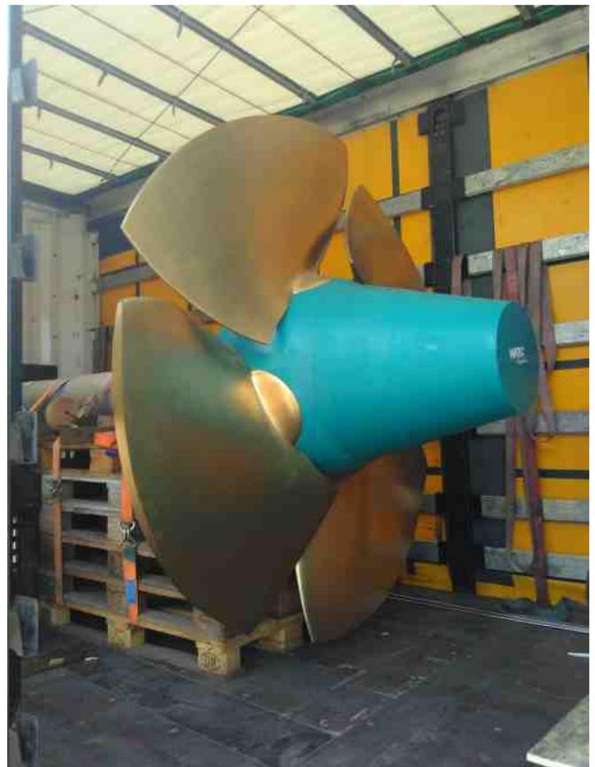
des niveaux, le régime du cours d'eau, l'encombrement des machines, l'impact sur les coûts de génie civil, etc. À Montferrand-le-Château nous devons probablement choisir entre les différents types de turbine Kaplan (qui a la forme d'une grosse hélice de bateau).
